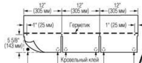
Отступить от каждого углового края 1" (25 мм) и нанести битумный kleй небольшим количеством. Отмерить от точек нанесения края 1 и 2 около 12" (305 мм) и нанести еще битумный kleй в двух местах.
